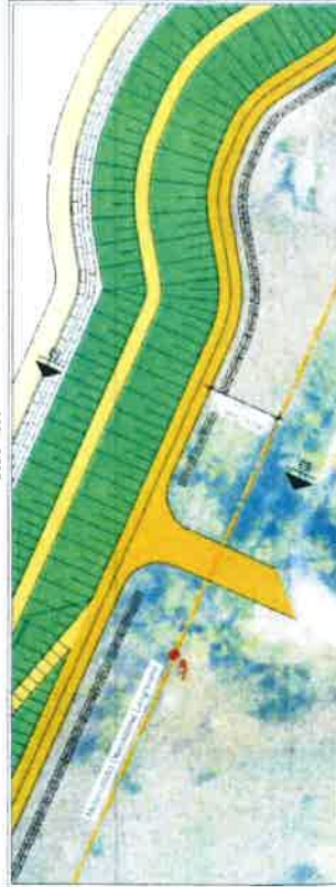
DETTAGLIO 3 - INTERFERENZA METANOCCIO CON RILEVATO ARGINALE CASSA COMPARTO 1 Scala 1:500
